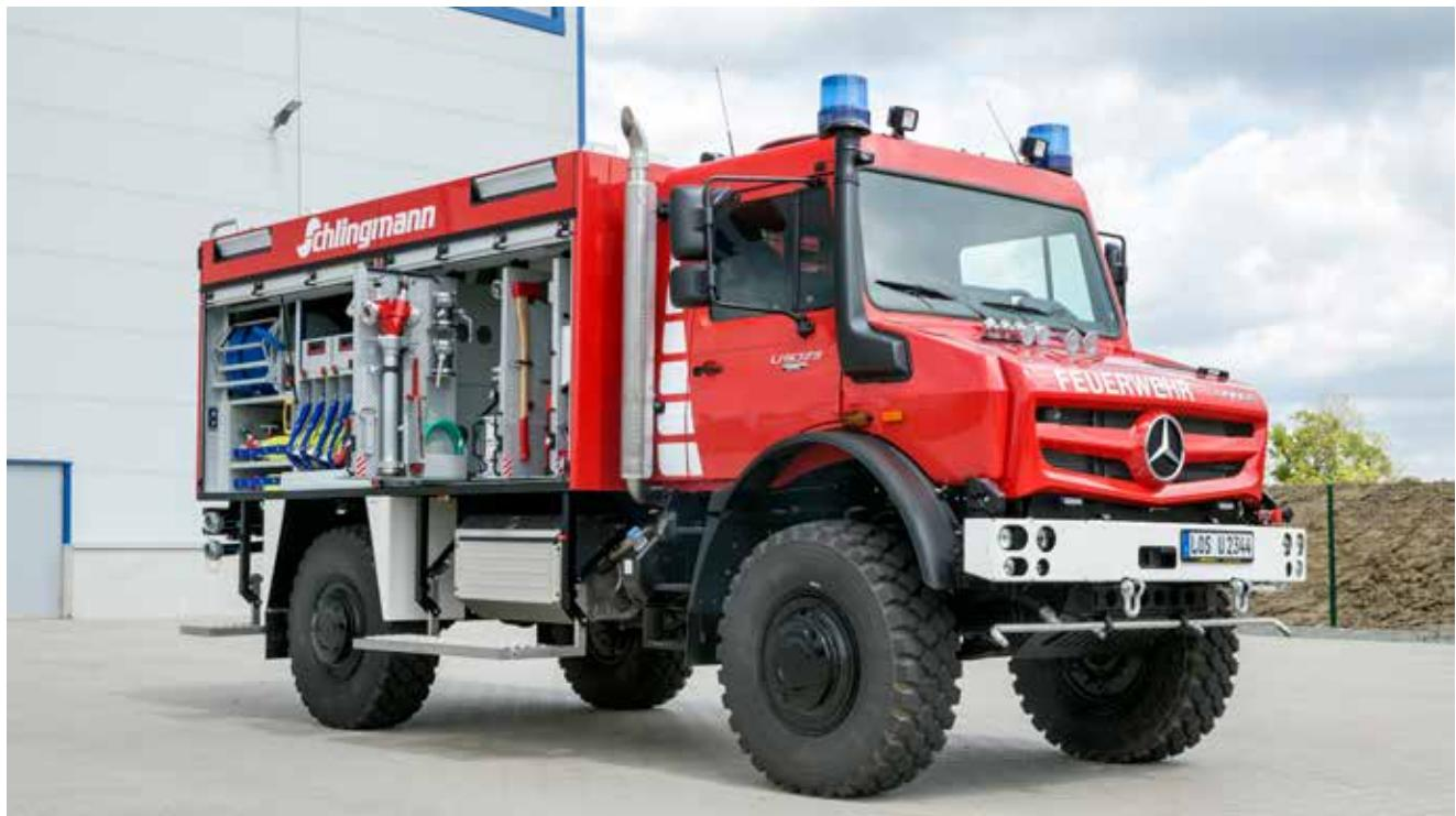
**Extrem robust und geländegängig** – dafür steht der Unimog U 5023. Allradantrieb, Portalachsen und Schraubenfedern sorgen für herausragende Bodenfreiheit und maximale Verwindung für beste Traktion im Gelände. Sein zulässiges Gesamtgewicht von 14,5 t ermöglicht eine Tankkapazität von mehr als 3.000 Litern. Das Fahrzeug entspricht damit der Norm für Tanklöschfahrzeuge TLF 3000 & 4000.
